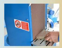
Adequado para processamento plano - Superfície de trabalho ajustável, reversível e substituível - Tensão da cinta e Sistema de centralização - Sistema de auto-filtragem de aspiração disponível - Guarda móvel para descobrir apenas a secção de correia usada - Velocidade de corte 19 m/seg
