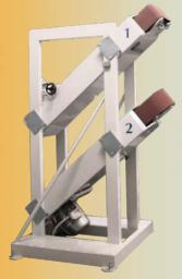
Cabeças de lixagem adequadas para instalação robótica Cabeça superior com pinça de cinta livre com diâmetro de roda equilibrado 150 mm
