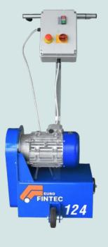
Adequado para remover rebarbas de soldadura ou polir grandes superfícies planas
