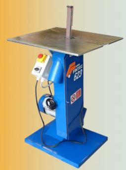
Ideal para trabalhos internos e externos em peças planas e moldadas Trabalho interno com diâmetro mínimo de furo de 30 mm Os braços tensores de correia são intercambiáveis com espessuras de 6 a 75 mm
