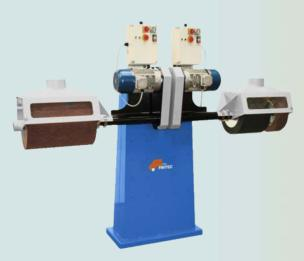
Máquina de lixar com dois motores independentes - Ideal para trabalhar peças grandes - O motor pode ser aparafusado em 7 posições a cada 140 mm de 500 mm a 1500 mm do chão - Placa para instalar motores a cada 35 mm disponível sob nova procura - Centrais eléctricas separadas e independentes - Sistema de aspiração autofiltrante para recolher o pó do ponto de produção.
