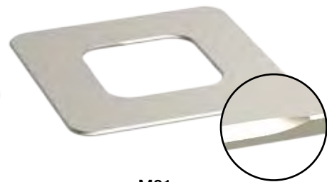
M31 REBARBADOR DEFORMAÇÃO
