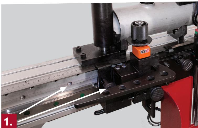
1. Fácil e preciso posicionamento com placa de índice em dois intervalos personalizados.
