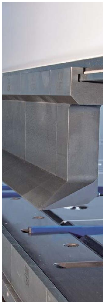
Lâmina de pé de cabra segmentada, aperto da ferramenta hidráulica
