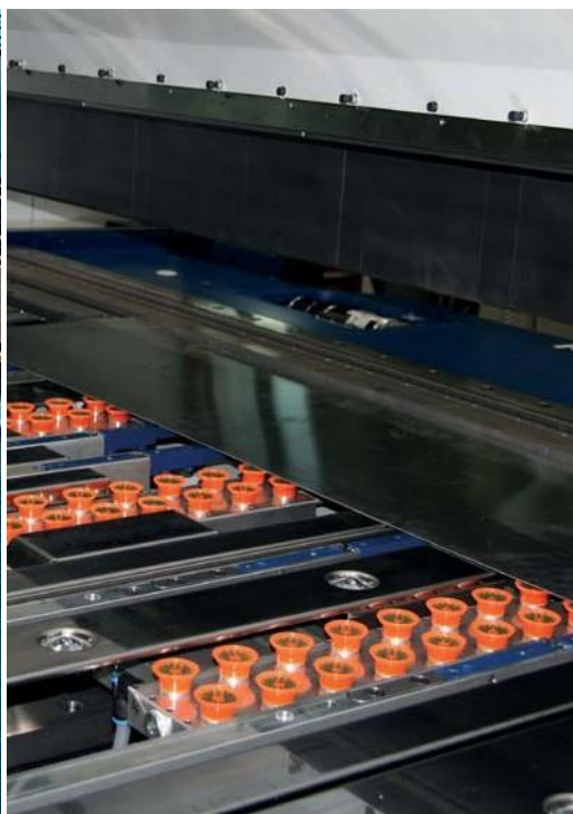
Com o opcional de ventosas todas as dobras podem ser feitas num único lado com um simples movimento do operador.
