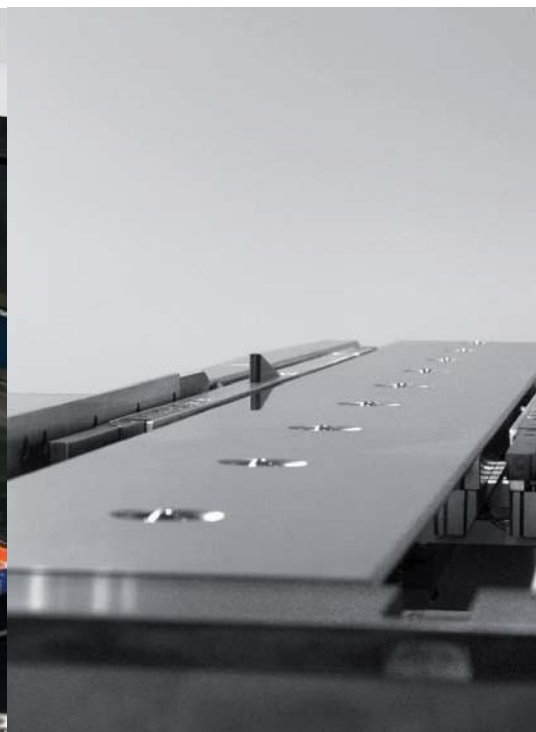
Pop up pneumática de batentes quadrados montados no lado do corredor e com o esbarro a garantir um posicionamento preciso da chapa.
