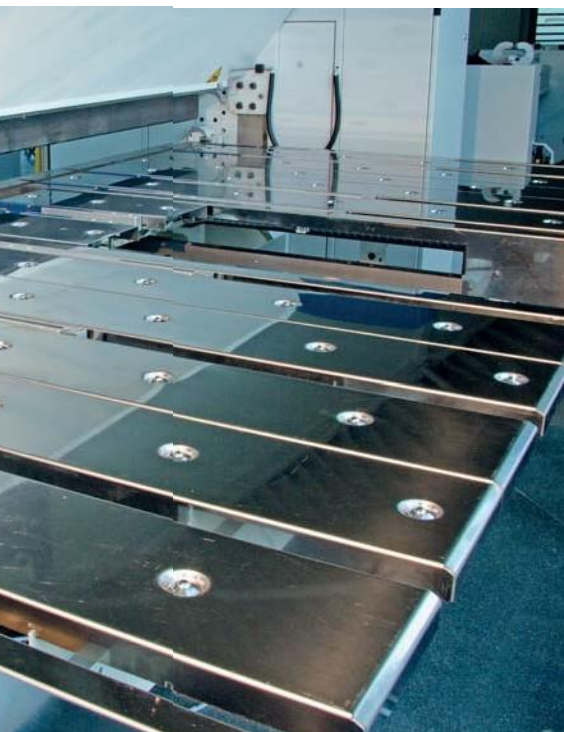
Esbarro em forma de U, com esferas na mesa para melhor manuseamento da chapa.
