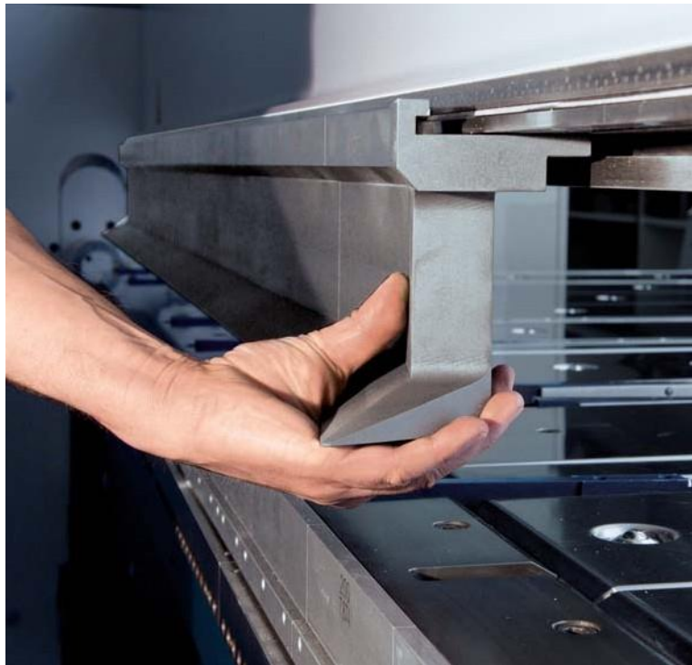
O dispositivo de aperto da ferramenta hidráulica reduz o tempo de montagem.
