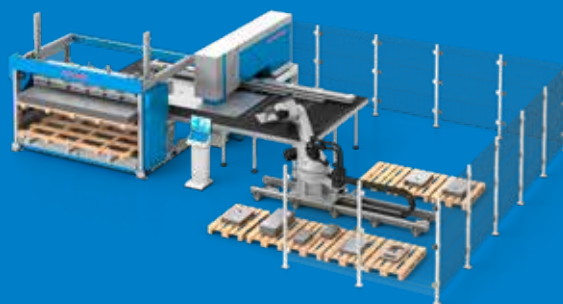
Sistemas de carga e descarga automática
