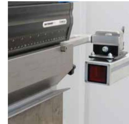
Permite ao operador trabalhar com segurança perto das ferramentas, mesmo quando a RAM e o esbarro se movem em alta velocidade. A velocidade máxima mantém-se até uma distância de 6 mm da peça. O sistema monitoriza continuamente o desempenho da velocidade do travessão superior, onde está o punção.
